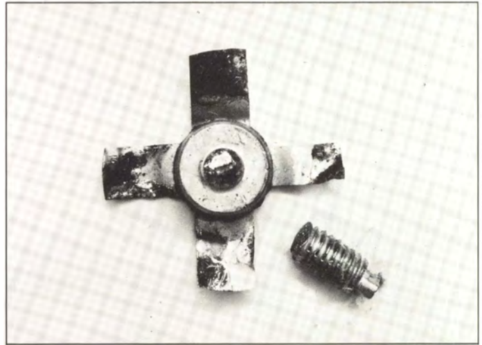
Fig. 6 - Transistore "stripline" deformato dall'inesatto montaggio: si noti la flangia ritorta.
